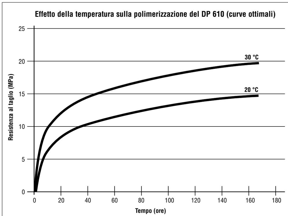
**Curve di polimerizzazione accelerata** Resistenza al taglio (MPa)
